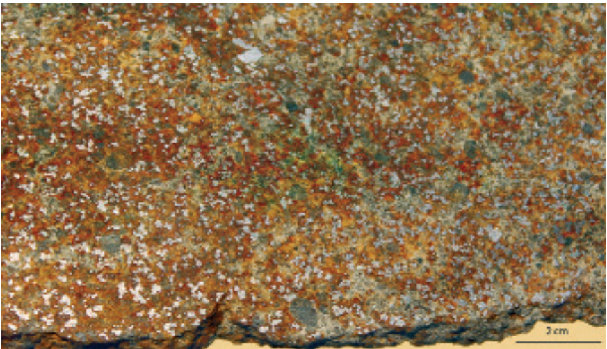
Figura 6. Fatia de condrito mostrando grãos metálicos de ferro-níquel com manchas de ferrugem ao redor, característica típica dos condritos (Foto da autora)
