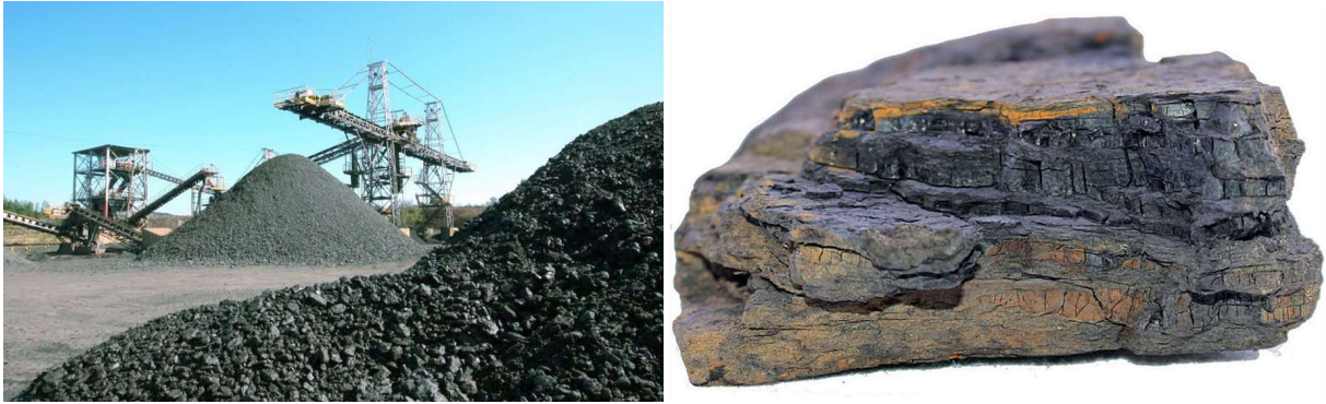
Figura 10 – À esquerda, exploração de carvão na Mina Guaíba, da empresa Copelmi, RS; à direita, amostra de carvão mineral oriunda da mesma mina, onde é possível identificar sedimentos alaranjados misturados ao carvão.
